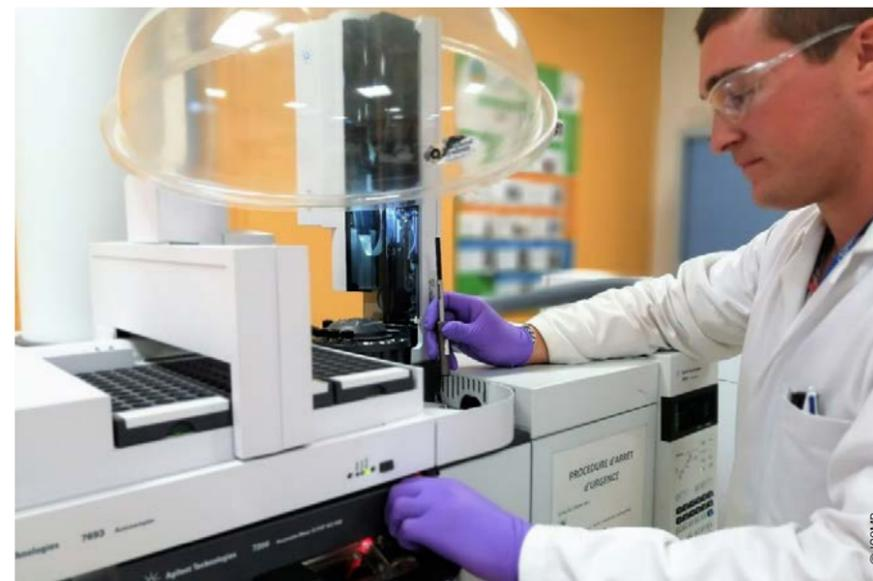
Analyse par SPME-GC-MS/MS de molécules expirées (instrumentations sur la plateforme PLATINA).
