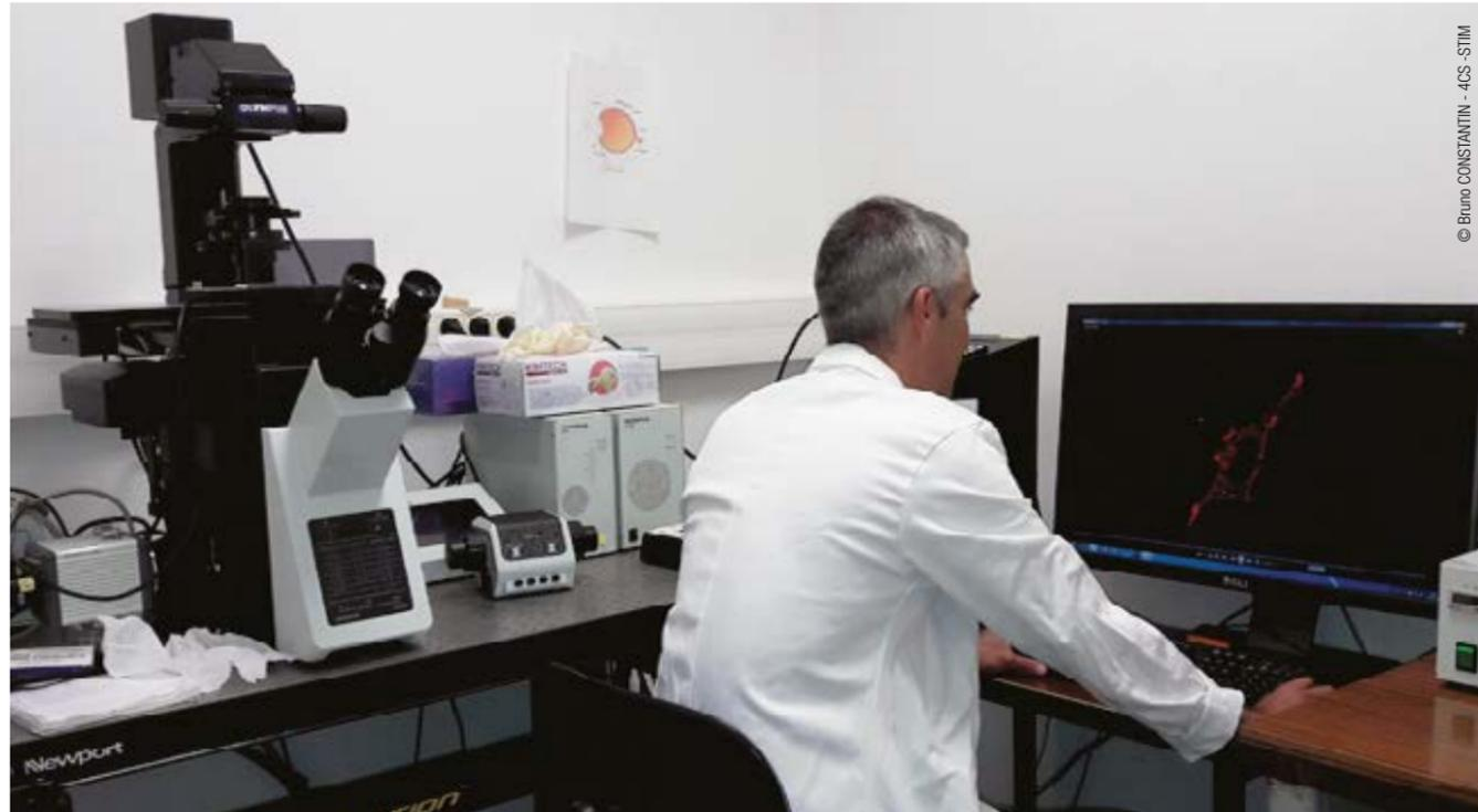
Microscope de fluorescence pour observer les signaux calciques ou les protéines canal et connexines dans les cellules vivantes.
