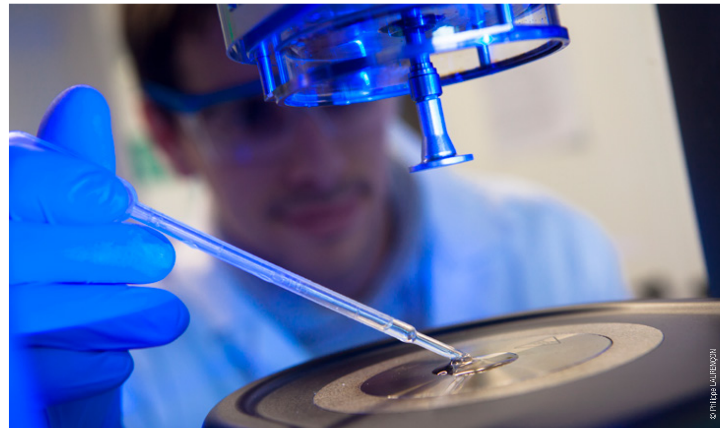
Étude des propriétés d'écoulement des précurseurs de céramiques grâce à un rhéomètre couplé à un spectromètre infrarouge
